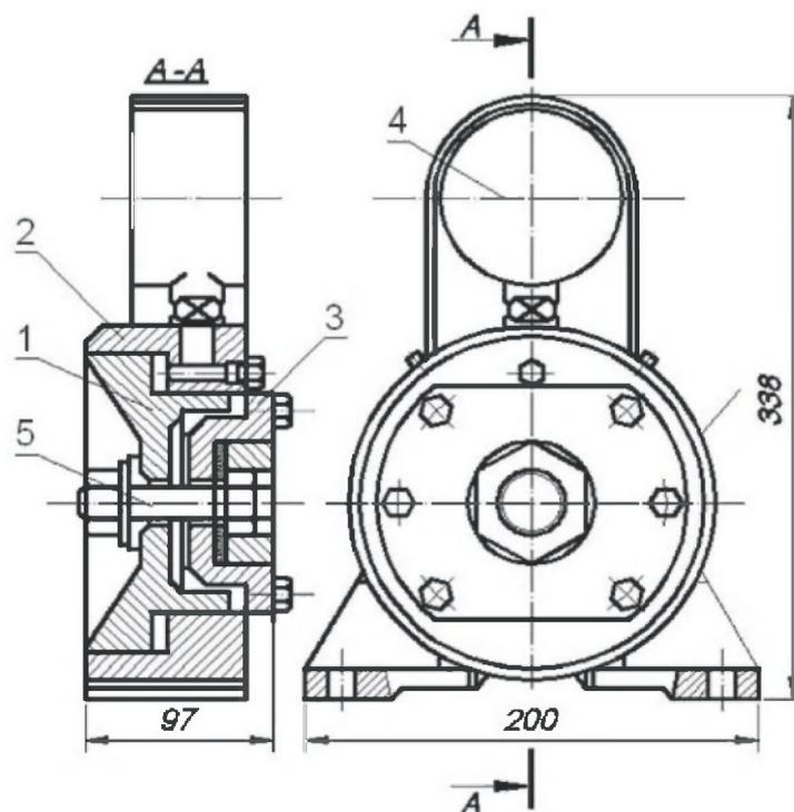
1 – поршень; 2 – корпус; 3 – фланец; 4 – манометр; 5 – испытываемый болт
