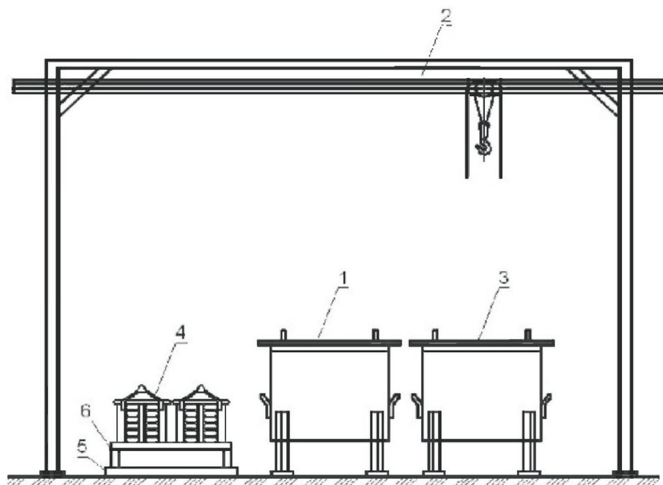
1 – ванна промывочная; 2 – подъемное устройство; 3 – ванна для кипячения;
