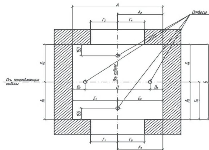
A, A1, Б, Б1, В – размеры, определяемые монтажным (установочным) чертежом.
