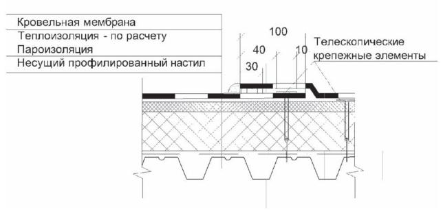
Рисунок 3 – Механическое крепление мембраны, уложенной на утеплитель
