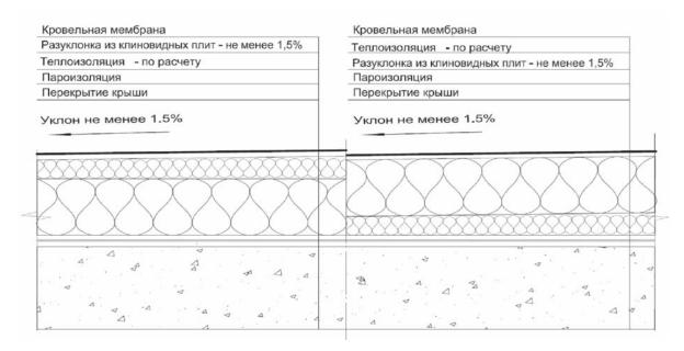
Рисунок 2 – Варианты уклонообразующего слоя из ТМ
